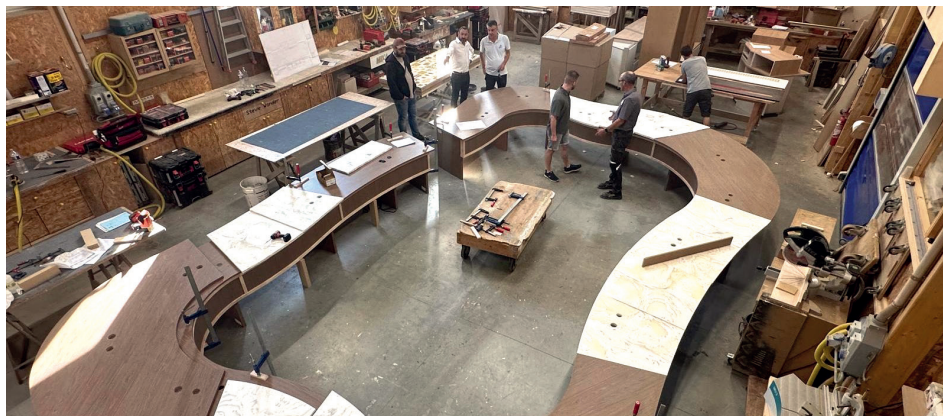
La table du conseil municipal en cours de fabrication au sein de l'entreprise Babin
